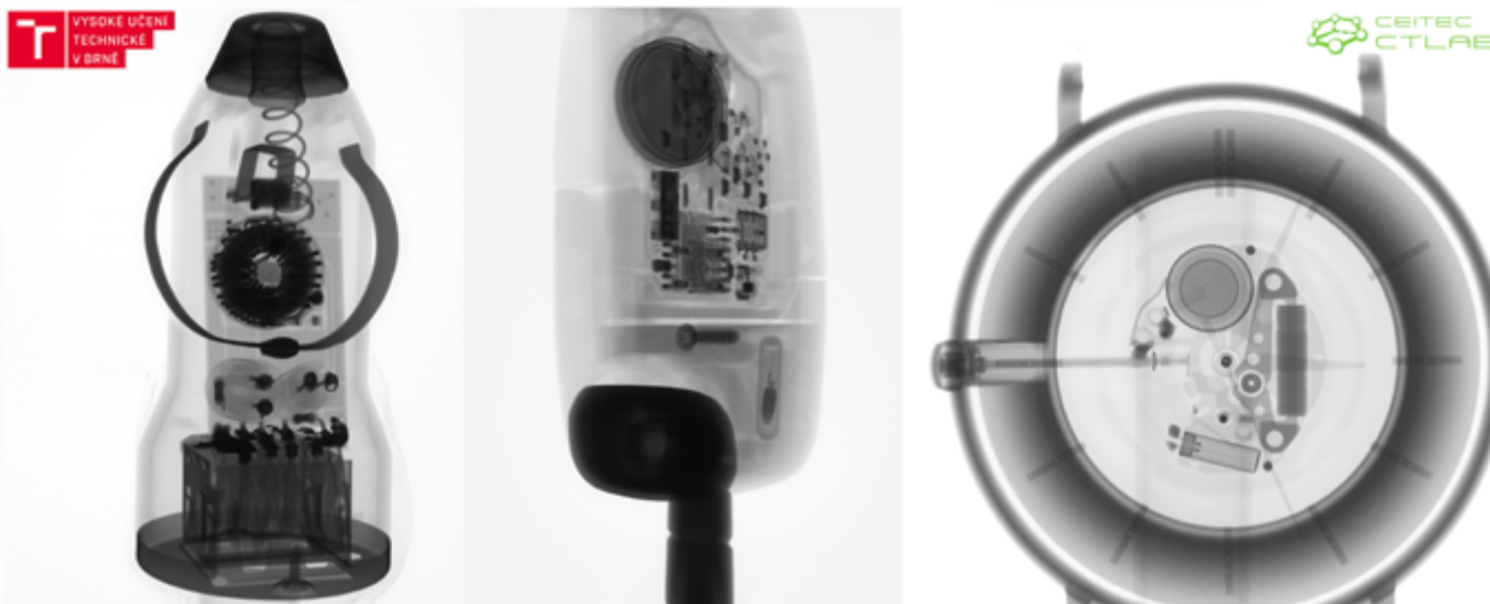
Obr. 8: Rentgenové snímky předmětů, které si přinesli návštěvníci. Zleva nabíječka, klíče od automobilu a hodinky.
